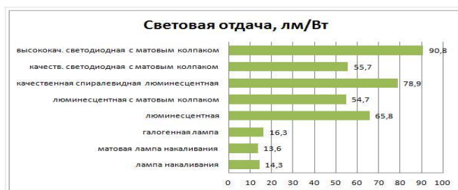
Рисунок 4- Светоотдача разных типов ламп
