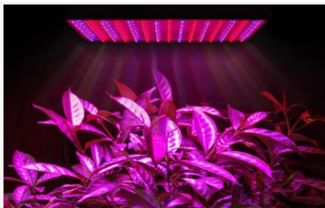
Рисунок 10 - Светильник для рассады с увеличенной синей составляющей
