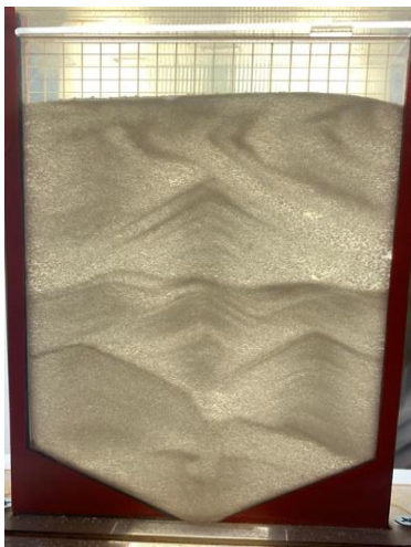
Рисунок 1. Формирование насыпи зерна по максимальной и минимальной влажности и массе принятой партии при послойной загрузке зернохранилищ.
