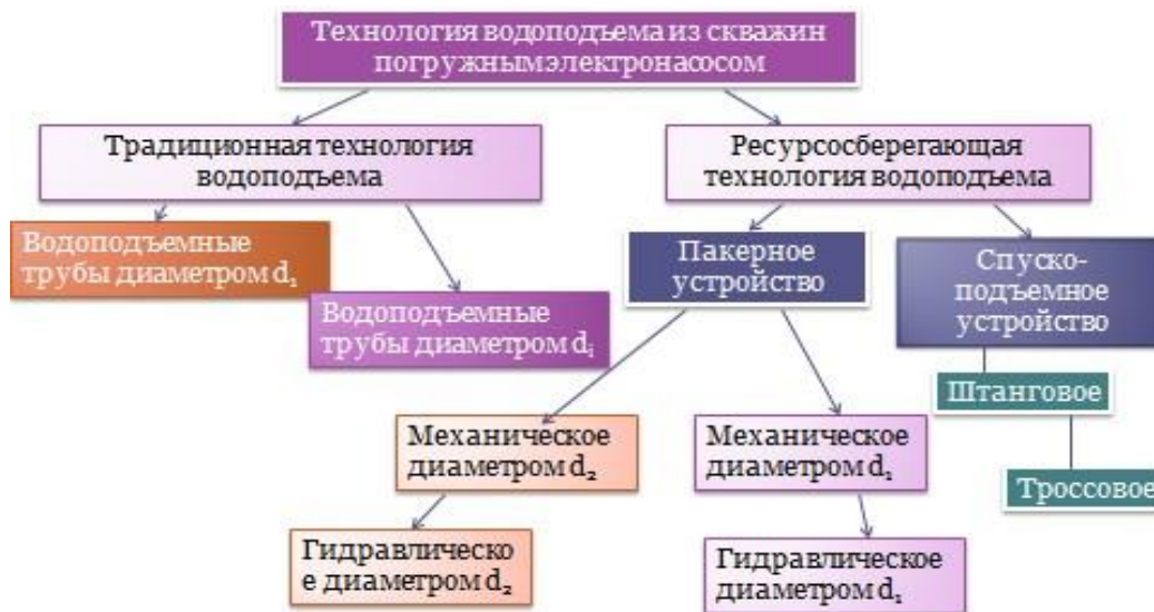
Рисунок 1 - Структурная схема технологии водоподъема из скважин погружным электронасосом Ресурсосберегающая (беструбная) технология водоподъема
